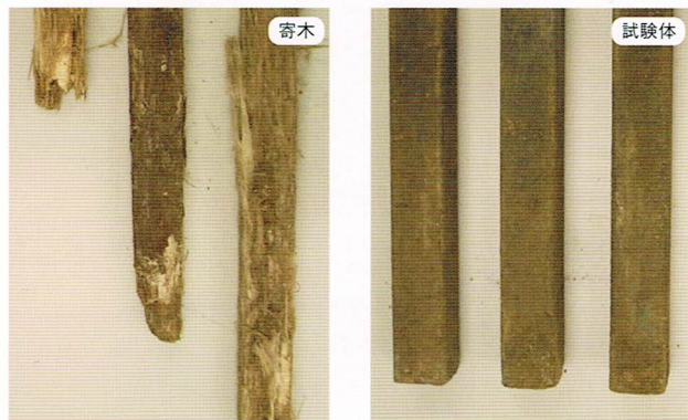
■ 塗装していない木片 独立行政法人 森林総合研究所 野外耐蟻性試験結果より
